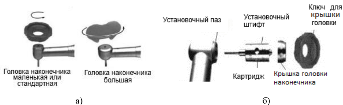
Рисунок 23 – Замена картриджа: а) снятие; б) установка.
