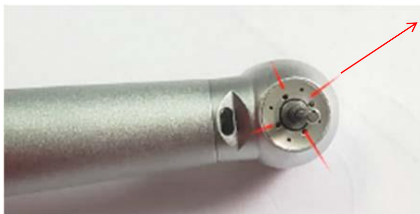
Рисунок 12 – Отверстия для подачи воды и воздуха, для прочистки которых используется игла
