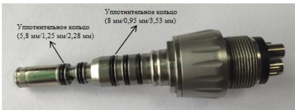
Рисунок 20 – Уплотнительные кольца на быстросъемном соединении
