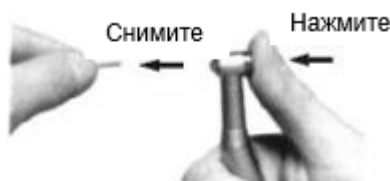
Рисунок 22 – Установка и снятие бора
