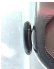
Рисунок 19 - Уплотнительное кольцо (5,8 мм/1,25 мм/2,28 мм)
